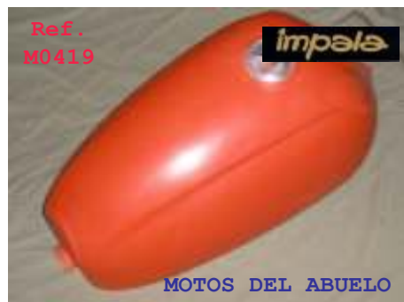
DEPÓSITO DE FIBRA CON ROSCAS PARA 2 GRIFOS
